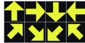
S-348b Señal variable de destino
